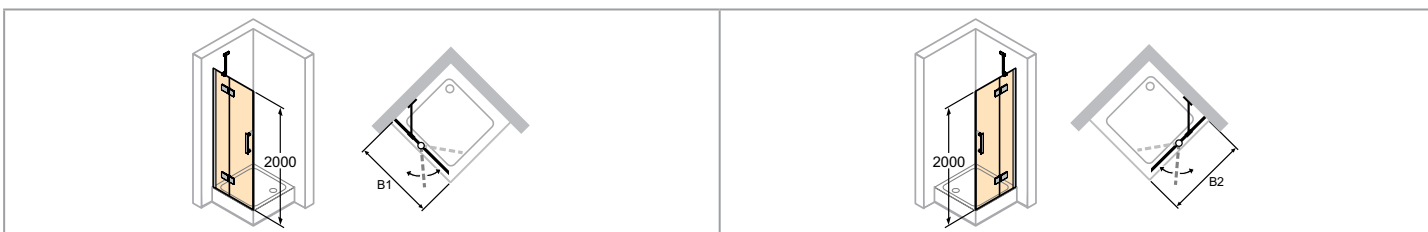
Vértice por mitades - Fijación izquierda
