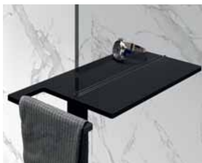
HÜPPE Select+ Shower Board con toallero integrado se sujeta al lateral con una tecnología de sujeción patentada, sin necesidad de taladros en el cristal. El panel HÜPPE Select+ Shower Board se puede adaptar universalmente en todos los laterales separadores con un grosor de cristal de 6mm / 8mm.
